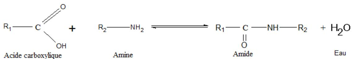
Figure 18: Réaction d'amidification
